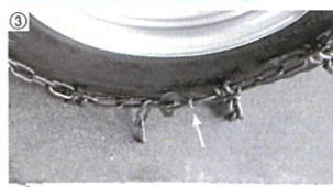
19 タイヤ外側のタイヤチェーンも、同じように仮止めします。フック(写真⑱矢印)は、タイヤチェーンのコマに通して回転させ、フックのストッパーを通し、スッパーに引っ掛けて固定します。
