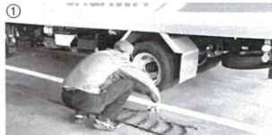
17 タイヤチェーンの裏を持って、タイヤにかぶせます。タイヤチェーンの長さは左右均等に、また、タイヤチェーンはタイヤにしっかりとかぶさるようにします(写真⑰)。
