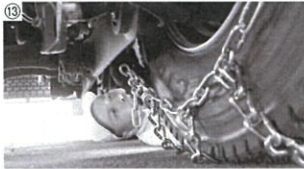
13 タイヤとタイヤの間のタイヤチェーンを固定し直します。一度フックを外してから、しっかりと固定し直しましょう(写真⑬)。
