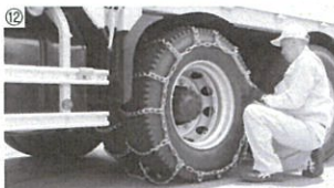
12 次に、タイヤチェーンを固定するため、車両を少し前に移動します。タイヤの3分の1から4分の1回転が目安です。車両を移動することで、タイヤチェーンが緩みます。タイヤにタイヤチェーンがしっかりとかぶるように調整しましょう(写真⑫)。
