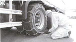
9 タイヤ内側・外側のタイヤチェーンも、同じように仮止めします(写真⑨)。
