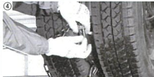
20 タイヤ内側と外側のタイヤチェーンを固定し直します。一度フックを外してから、しっかりと固定し直しましょう(写真⑳)。
