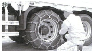
16 バンドの形は正六角形になるように固定します。固定は対角線の順番がよいでしょう(写真⑯)。
