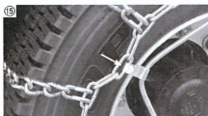
15 タイヤ外側のタイヤチェーンをバンドで固定します。バンドのフックを、タイヤチェーンのコマに引っ掛けます。フックは外側を向くようにしてください(写真⑮矢印)。
