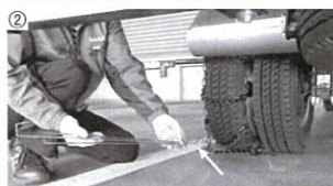
18 タイヤ内側のタイヤチェーンを仮止めします。この時、タイヤチェーン装着用の金具(矢印)を使うと便利です。引き出したタイヤチェーンの一端を、もう一方のフックに引っ掛けて、仮止めします。仮止めでもタイヤチェーンが外れないようにしっかりと固定します(写真⑱)。
