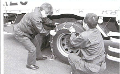
同社のドライバーがタイヤチェーンメーカーの担当者からの指導を受けながら、チェーンの装着法を学ぶ
