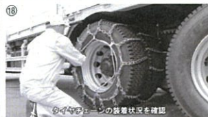
24 チェーン装着後、おおよそ300mくらい走行してから、一度タイヤチェーンが外れていないかを確認してください。緩んでいる場合は、もう一度固定し直します(写真㉔)。
